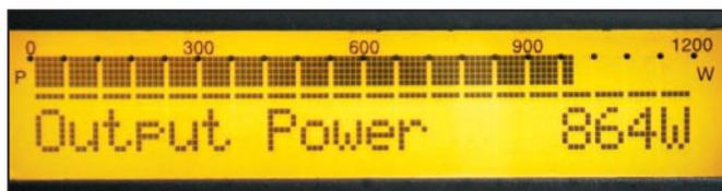
Le LCD où s'affichent les paramètres de fonctionnement.
